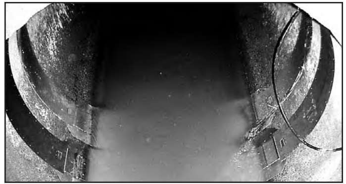
Figure 4: Isco area-velocity meter probe
